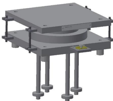
Bild 6: Lagertyp PKf, mit Rückverankerung gegen klaffen der Fuge, oben Stahl & unten Betonanschluss.
